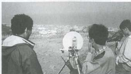
▲75GHzの相手局との方向合わせの様子。相手は1.2km先にいる
