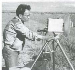
▲75GHzの実験は距離を結んで行った。方向を再調整するJA8CMY
